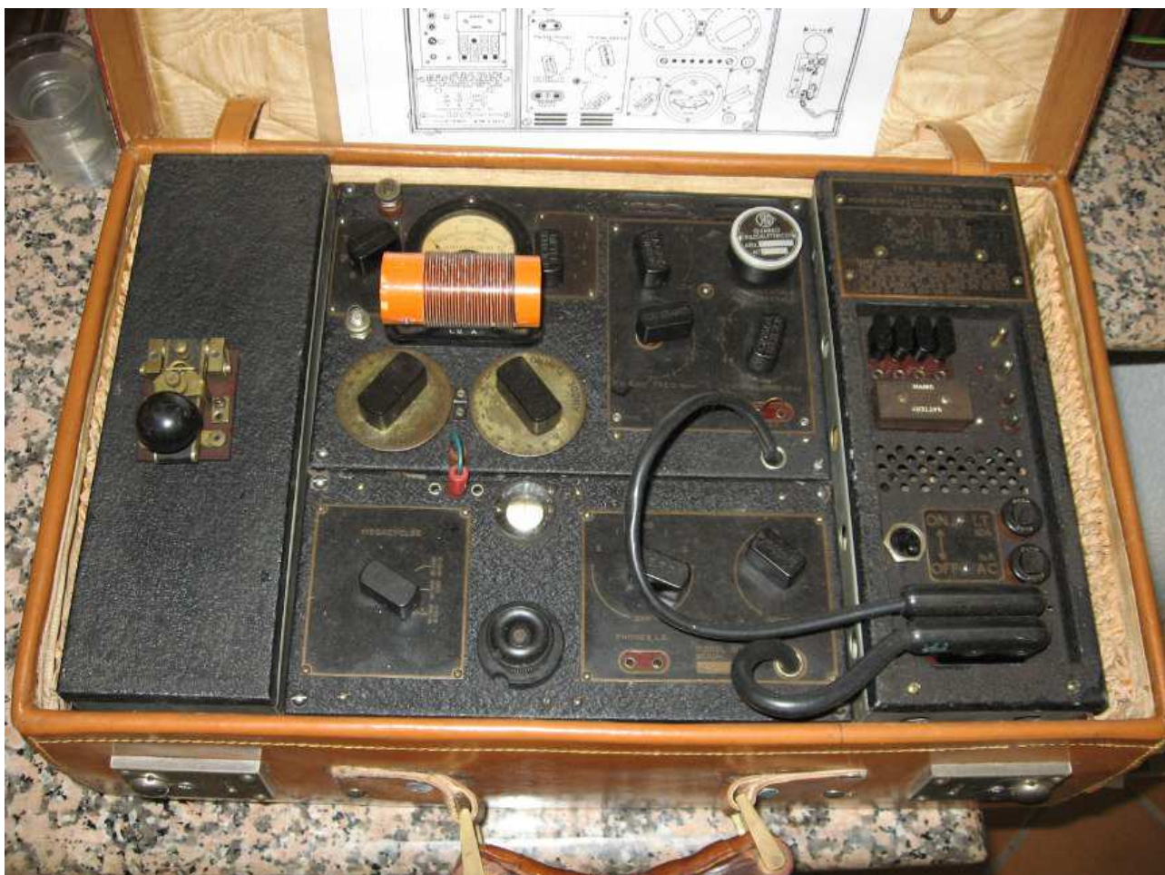
Foto dell'apparecchio completo che mostra la bobina color arancio inserita nella sua sede, il quarzo ( rotondo in alto a destra della bobina ) e i 2 cavi neri che collegano RX e TX all'alimentatore
