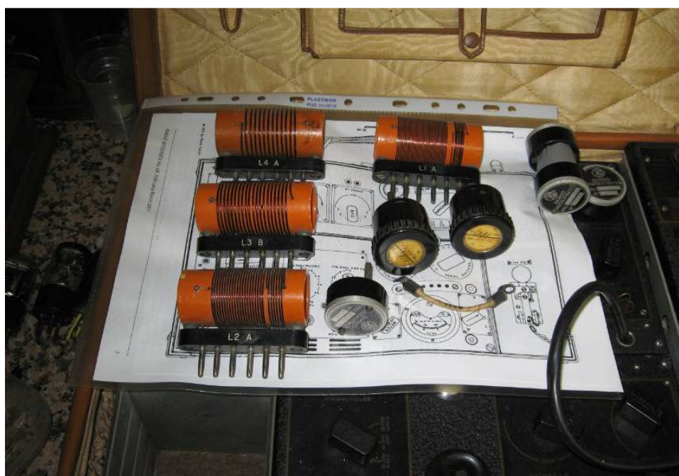
Foto dell'apparecchio completo che mostra la bobina color arancio inserita nella sua sede, il quarzo ( rotondo in alto a destra della bobina ) e i 2 cavi neri che collegano RX e TX all'alimentatore
